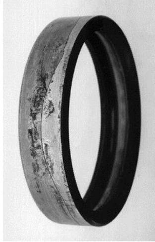
Figura 3.69. Rachadura longitudinal no anel externo do rolamento rígido de esferas com corrosão por contato [2].
