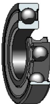
Figura 3.27. Rolamento para temperaturas extremas [2].
