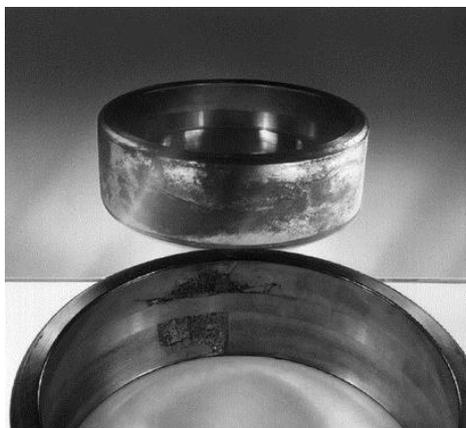
Figura 3.62. Descascamento nas pistas do anel externo de um rolamento autocompensador de rolos. Área correspondente de corrosão por contato avançada na superfície externa (para esta foto, o anel foi colocado na frente de um espelho) [2].
