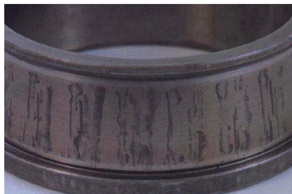
Figura 3.46. Corrosão no anel interior de um rolamento cônico. A corrosão tem um espaço equivalente a distancia entre elementos rolantes. A corrosão é produzida pela presença de água no lubrificante [2].
