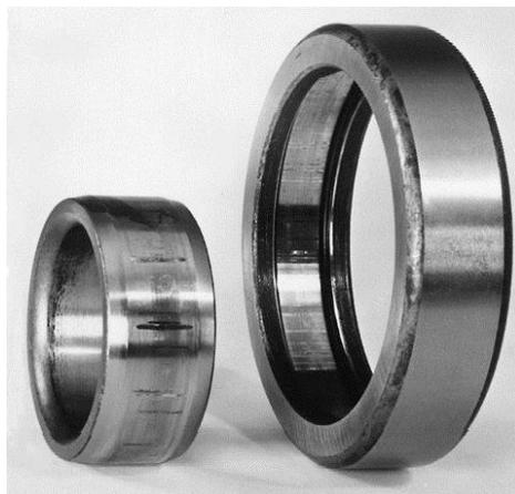
Figura 3.35. Anel interior e exterior de um rolamento de rolos cilíndricos expostos a vibrações [2].
