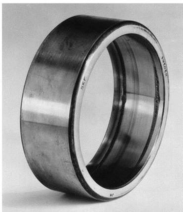
Figura 3.63. Descascamento causado por crateras por passagem de corrente elétrica [2].
