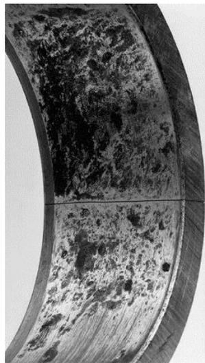
Figura 3.68. Anel interno do rolamento autocompensador de rolos com corrosão por contato e rachadura transversal por todo o anel. A corrosão por contato causou a rachadura [2].
