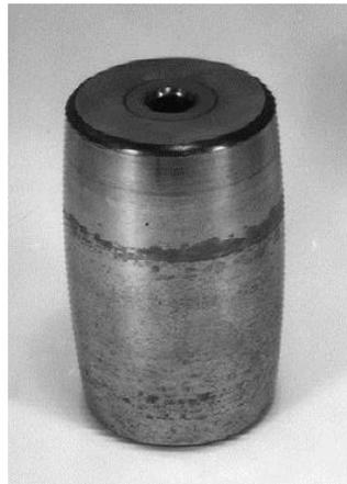
Figura 3.45. Fadiga superficial em forma de uma faixa em torno o rolo de um rolamento autocompensador de rolos [2].
