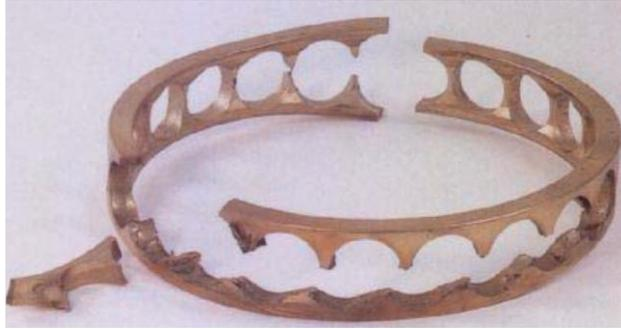
Figura 3.71. O desgaste na gaiola de um rolamento de esferas é causado pela lubrificação inadequada [2].
