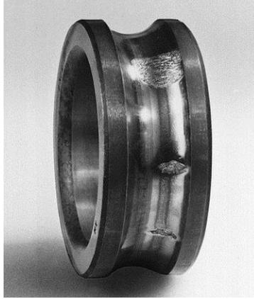
Figura 3.59. Descascamento causado por endentações [2].
