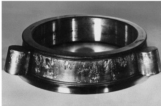
Figura 3.55. Descascamento causado por cargas pesadas e lubrificação inadequada [2].
