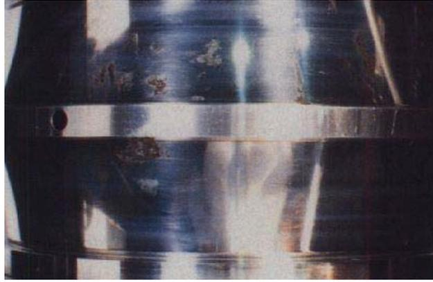
Figura 3.47. Corrosão no anel interior de um rolamento autocompensador de rolos, produzido pela entrada de água no rolamento [2].
