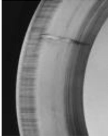
Figura 3.51. Estriamento, causado pela passagem de corrente elétrica, no anel externo de rolamento autocompensador de rolos [2].
