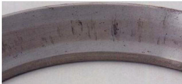
Figura 3.48. Corrosão no anel exterior de um rolamento cônico. A corrosão tem um espaço equivalente à distância entre elementos rolantes. A corrosão é produzida pela presença de água no lubrificante [2].
