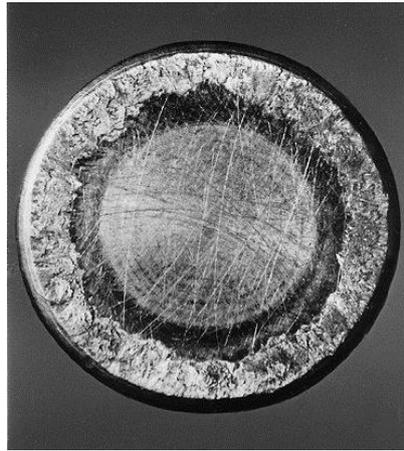
Figura 3.39. Rolo cilíndrico com espalhamento no extremo, infligida por forte carga axial e lubrificação inadequada [2].
