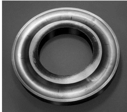
Figura 3.36. Arruela de um rolamento axial de esferas sujeito a sobrecarga fora de operação. As endentações são estreitas e alinhadas radialmente, não esféricas como nos rolamentos radiais de esferas [2].
