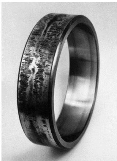
Figura 3.43. Superfície exterior com espalhamento no anel exterior de um rolamento autocompensador de rolos [2].
