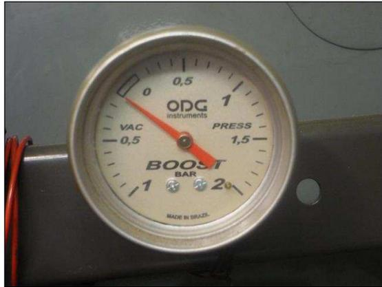
FIG. 5.5. Manômetro utilizado na Medição da Pressão na Admissão.
