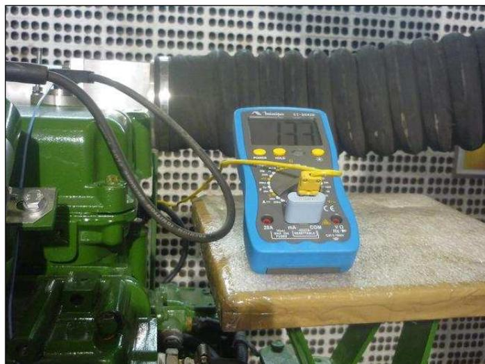
FIG. 5.4. Multímetro Digital usado para a Leitura da Temperatura.
