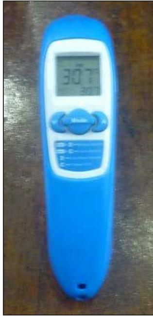
FIG. 5.9. Medidor Infravermelho da Temperatura.
