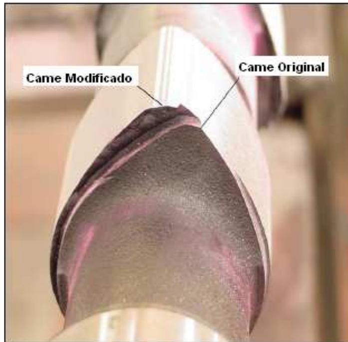
FIG. 1.5 Preparação do novo eixo comando de válvulas.
