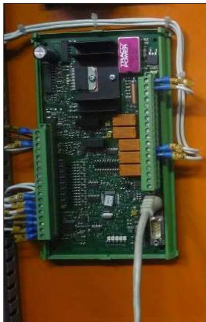
FIG. 5.6. Placa Controladora do Lambda no Motor.
