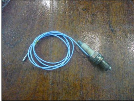
FIG. 5.12. Sensor de Pressão AVL GH 13Z-24.
