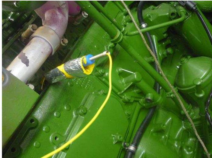
FIG. 5.3. Termopar tipo K instalado no Cabeçote do Cilindro.
